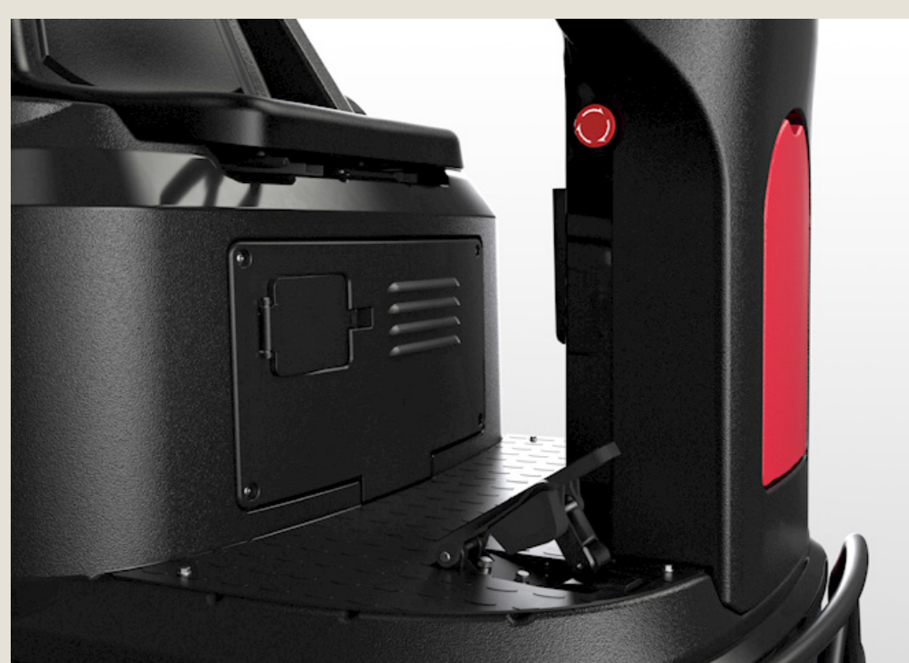
将电池充电器连接到机器上的充电口，并打开充电器。
