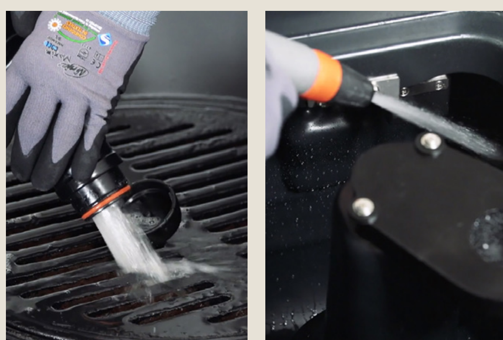
利用后方的软管清空水箱。清空并清洁水箱中的碎片盘，冲洗并清洁污水箱。
